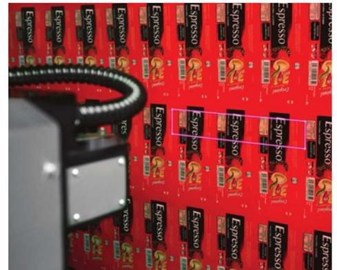
SLC 350HD+ wird standardmäßig mit Zieldiode geliefert; er beschleunigt Korrekturen und reduziert Umrüstzeiten und Abfall
